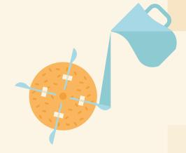
La cantidad de agua que echamos con la jarra representa el caudal y la distancia representa la altura del salto, por lo que se pueden hacer distintas pruebas incrementando o disminuyendo la altura del salto y el caudal. Para aprovechar la energía, es necesario que haya una corriente o movimiento de agua. Mediante generadores, se puede transformar esa energía hidráulica en energía eléctrica.
