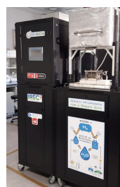
1 kW electrolyser (Barcelona)
