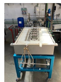
5 kW electrolyser (CELSA)
